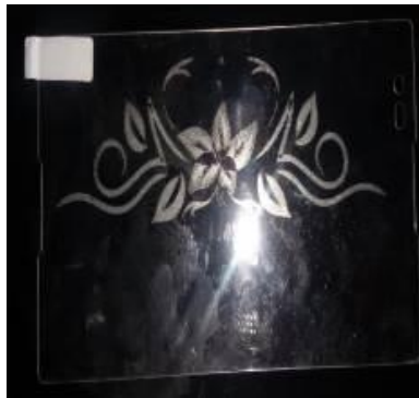
شكل (10) يوضح الحصول على التشكيلات البارزة والغائرة بواسطة أشعة الليزر
